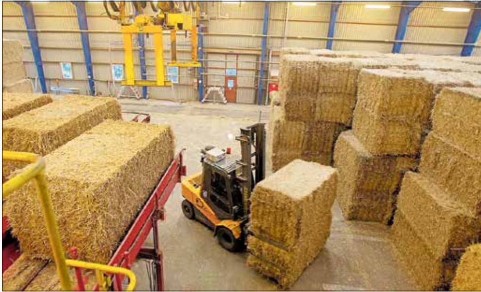
Haslev Fjernvarmes halmklade rummer kun brændsel til to-tre døgn drift. Det planlagte flisværk vil kunne køre dobbelt så lang tid på et fyldt lager. Det halverer antallet af lastbilkørsler. Foto: Thomas Olsen
